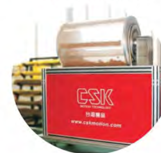
直线导轨防尘测试
